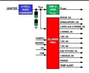
FIGURE 1. COMPUTER SYSTEM POWER MANAGEMENT SOLUTION
