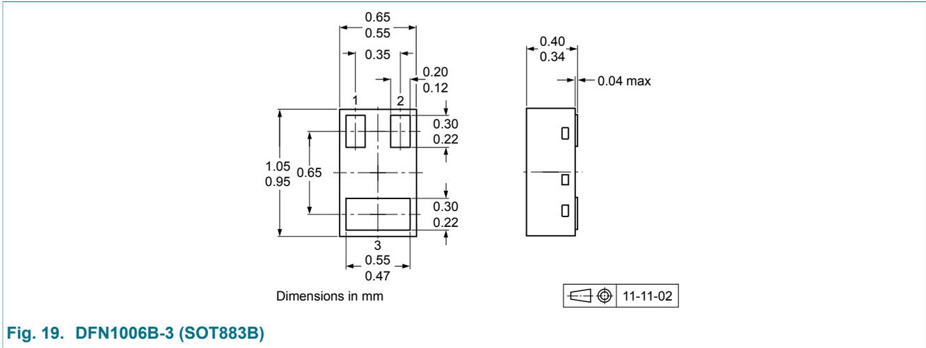
Fig. 19. DFN1006B-3 (SOT883B)
