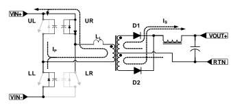
FIGURE 12. UPPER SWITCH TOGGLE AND RESONANT TRANSITION
