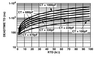
FIGURE 3. DEADTIME (DT) vs CAPACITANCE
