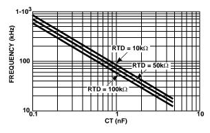
FIGURE 4. CAPACITANCE vs FREQUENCY
