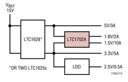
Figure 14. 2-Step Conversion Block Diagram
