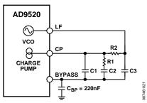
Figure 27. PLL Loop Filter
