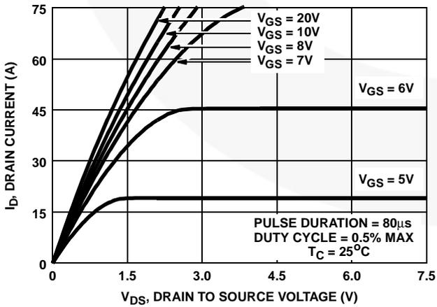
FIGURE 7. SATURATION CHARACTERISTICS
