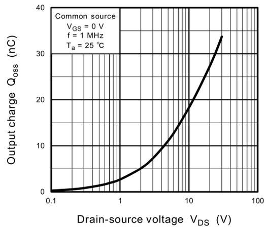
**Fig. 8.12  $Q_{oss} - V_{DS}$**
