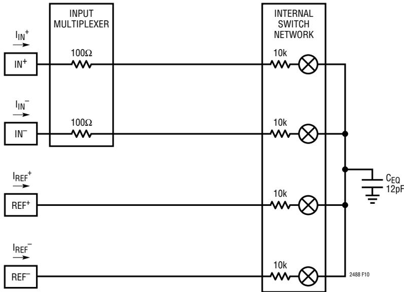
$$I_{IN^+}^{AVG} = I_{IN^-}^{AVG} = \frac{V_{IN(CM)} - V_{REF(CM)}}{0.5 \cdot R_{EQ}}$$
