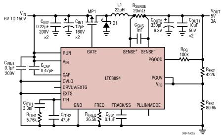
C<sub>VIN1</sub>: 0.1µF 200V MURATA GRM31CR72D104KW03L C<sub>CAP</sub>: 0.47µF 16V MURATA GCM188R71C474KA55L C<sub>IN1</sub>: 12µF 160V ILLINOIS CAPACTOR 126AVG160MGBJ C<sub>IN2</sub>: 0.22µF 200V MURATA GRM32DR72D224KW01 R<sub>SENSE</sub>: 20mΩ SUSUMU KRL3216E-M-R020-F-T1 L1: 22µH WURTH ELEKTRONIK 7447709220
