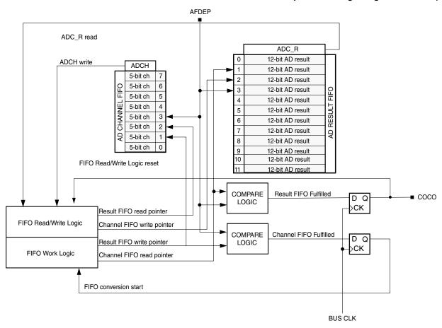
Figure 24-9. FADC FIFO structure
