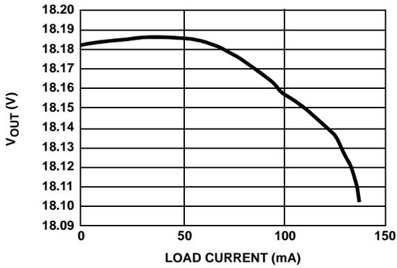
FIGURE 11. LOAD REGULATION (V<sub>IN</sub> = 3.6V)
