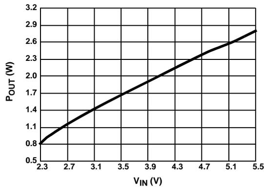
FIGURE 15. RECOMMENDED MAXIMUM OUTPUT POWER vs INPUT VOLTAGE
