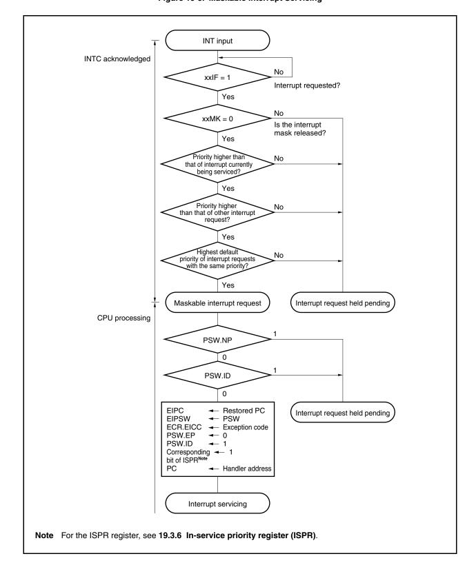
Figure 19-5. Maskable Interrupt Servicing
